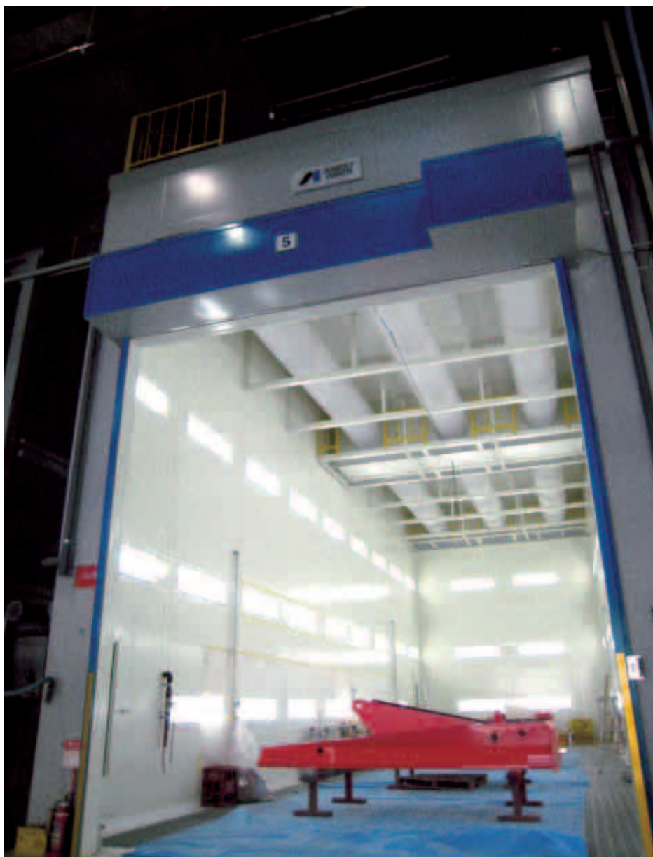
塗装ブースの外観。
