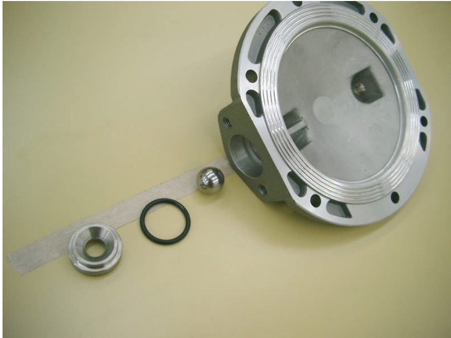
下部の吸込弁の部品状況
