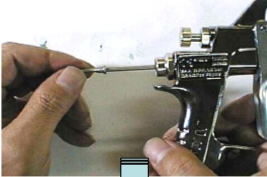
ニードル弁挿入後、ニードル弁バネと塗料調節ツマミを手で後方から締め付ける。
