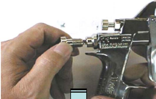
引き金を引きながら塗料ノズルを手で締め込む。
