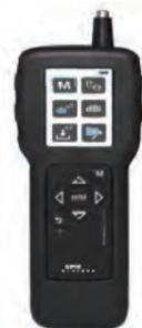
コンプレッサ本体の測定プラグに測定器を差し込む簡単診断システムになります。コンプレッサ本体のベアリング振動の測定により、コンプレッサ本体の状態を診断できます。ベアリングの状態をチェックすることで予防保全と適切なオーバーホール時期の見極めが可能になります。
