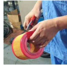
図9.1 吸込みフィルタの清掃
