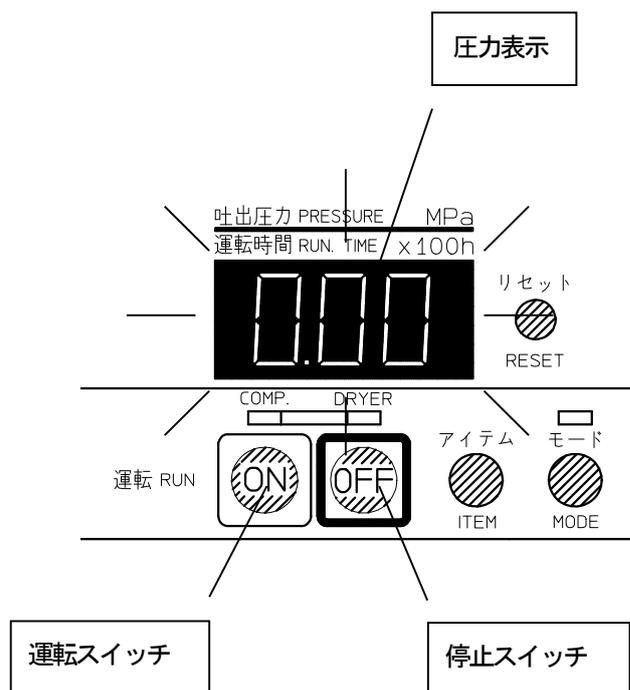
◆ドライヤ付きセットでも、運転スイッチを押した後、もう一度運転スイッチを押すことによりコンプレッサを運転させることができます。ただし、この場合はドライヤが安定状態に達していないために、吐出空気に水分が含まれることがあります。
