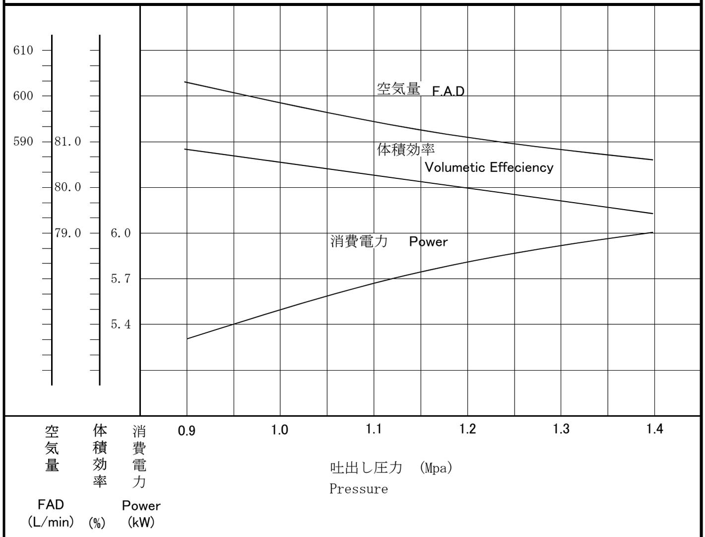
注意 1. 上表の吐出し空気量は、最高圧力時に吐出す空気量を吸い込み状態に換算した値です。
