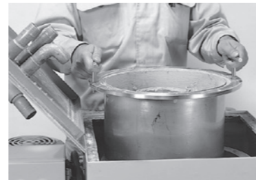
BR-12B 形は遠心槽に内容器を設け、スラッジ取出し質量の軽減を図りました。
