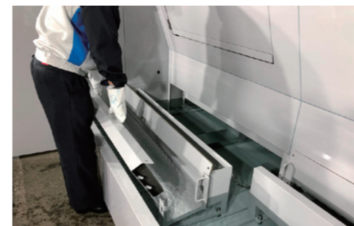
渦巻室前板、仕切り板を着脱式とし、受け皿と渦巻室を連結式にした為、容易にメンテナンスを行えます。
