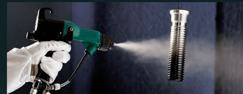
複雑な形状のパーツの塗装も静電スプレーなら塗料が回り込みしっかりと塗装ができます
