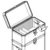
エアークイックハンガーは、図のように上部収納BOXの側面に取り付けます。
