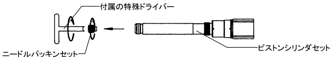
手順 6 ピストンシリンダセット内部から、マイナスドライバーでシールガイドねじ回して外し、Oリング(13-8)を抜取ります。新しいOリングをピストンシリンダセット内部に挿入したら、マイナスドライバーでシールガイドをねじ回し、Oリングを固定します。
