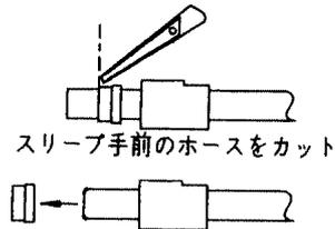
手順 4 ジョイント2、中間パイプ、スリーブ、ジョイント3を静電塗料ホースから外します。(ここで分解したスリーブは再使用可能です。)
