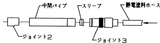
手順 3 ジョイントに静電塗料ホースをしっかり最後まで(約10mm)入れてから、付属のモンキーレンチでジョイントをジョイント2にねじ込み、スリーブを締め込みます。
