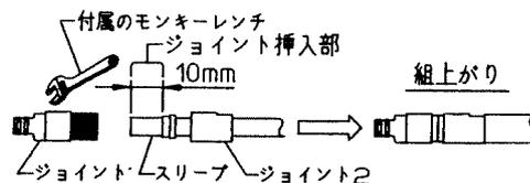
手順 4 本体に手順3で組み立てた静電塗料ホースを、ジョイント3で、真直ぐ奥迄押し込み、(静電ガンの後部面にジョイント3のねじ部が当るまで押し込む[下図参照])、それからジョイント3をねじ回し、最後に付属のモンキーレンチでジョイント3を締めこみ、静電塗料ホースを固定します。
