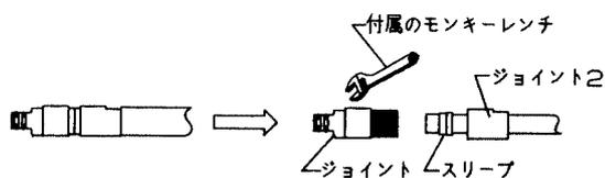
手順 3 ジョイント2のスリーブが静電塗料ホースに食い込んでいますので、下図の様にスリーブ手前のホースをカットして、スリーブを静電塗料ホースから外します。
