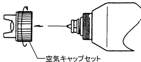
手順2 引金を引きながら塗料ノズル(2)に付属のスパナを掛けねじを緩めて外します。
