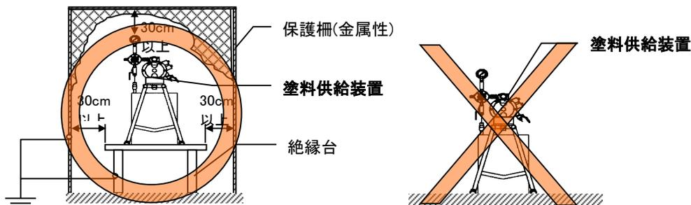
⑥ 低抵抗塗料、電気リーク性があるメタリック塗料で塗装する場合、塗装中、塗料容器内の塗料が少なくなり、塗料補給を行う時は、必ず静電コントローラ:EBC-122(別売)の電源をOFFにしてから塗料補給を行ってください。高電圧荷電中に塗料補給を行うと塗料に引火する可能性があります。
