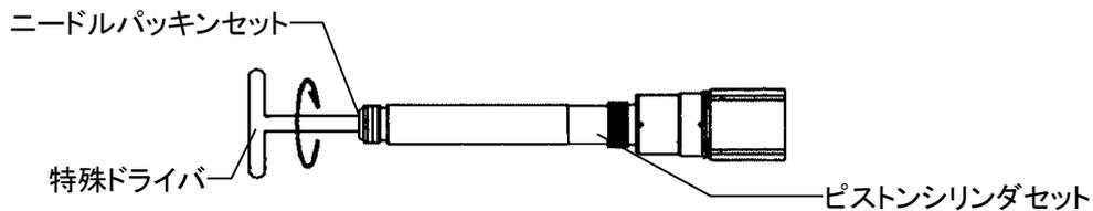
手順4 付属の六角ボルトをピストンセット後部ねじ穴にねじ込み、ねじ込んだ六角ボルトを掴み(ペンチでも可)、ピストンセットを引抜きます。
