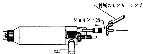
手順 2 付属のモンキーレンチでジョイントとジョイント2を外します。
