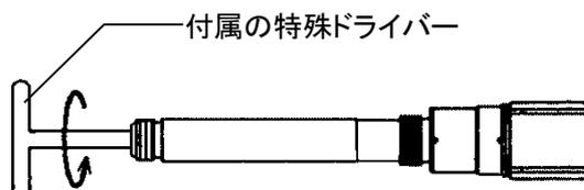
手順 12 中間シートが接続するねじ部(雄ねじ)にロックタイト#242 を塗布し、付属の片ロスパナで中間シートを手で最後までしっかりと締めこみます。
