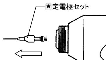
(2) 空気キャップセット(2)・塗料ノズル(2)・固定電極の取り付け。
