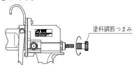
手順-2 ニードル弁ばね、ニードル弁棒セットを引き抜きます。
