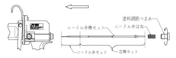
手順-2 ニードルパッキンセットを特殊ドライバで軽くねじ込み、ねじが止まってからさらに約30°締め増します。
