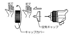
手順一2 引金を引きながら塗料ノズルの六角面にモンキーレンチを掛けねじを緩めて外します。
