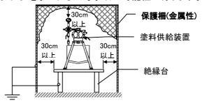
② 塗料、塗料ホース、塗料供給装置を絶縁して使用している場合(静電ガン:E-M10C シリーズ+ 絶縁台を使用する場合)、塗装機器の洗浄・保守・点検等により静電ガン、塗料供給装置および 塗装現場の金属に触れるときには、静電コントローラの電源を OFF した後、 必ず、アース線又は接地棒(アース接地されている金属棒)を接触させたままで作業を行なってください。
