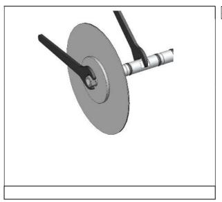
手順4 ロッドの中心部を押さえ、六角ナットを外し、 下記の部品をロッドより順番に取り外します。 (手順2と同様)
