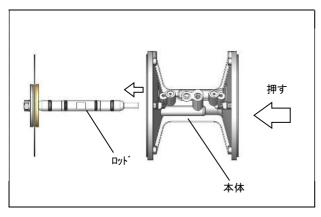
手順3 六角ナットの外れた側から、ロッドを押しながら、 六角ナットの外れていない側のダイアフラムを つかんで、本体からロッドを引き抜きます。
