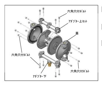
手順1 ポンプ上部の六角穴付きボルト×4個を外し、 アダプター上セットを取り外します。
