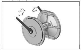
手順1 ダイアフラムの両側にある六角ナットを、両側 から同時に緩めます。 どちらか一方のナットが取り外せます。
