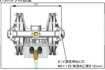
手順1 ポンプのアダプター下にM8の取付穴 が2ヶ所あることを確認します。
