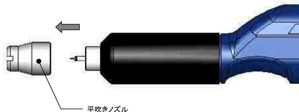
手順一4 ノズルカバーを手で反時計方向に回して緩め、ノズルカバーと電極ノズルセットを取り外して下さい。
