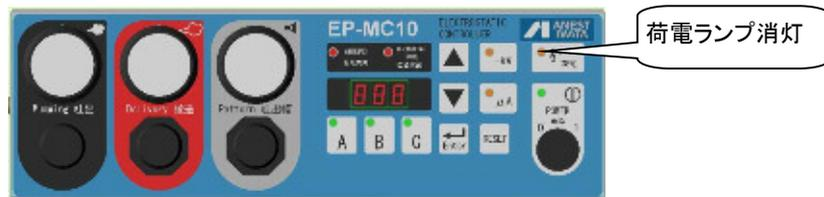
手順ー5 コントローラの電源を OFF にします。
