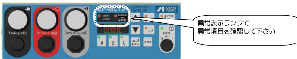
手順-2 異常項目を確認したら、リセットキーを押し、警告ブザーを停止して下さい。
