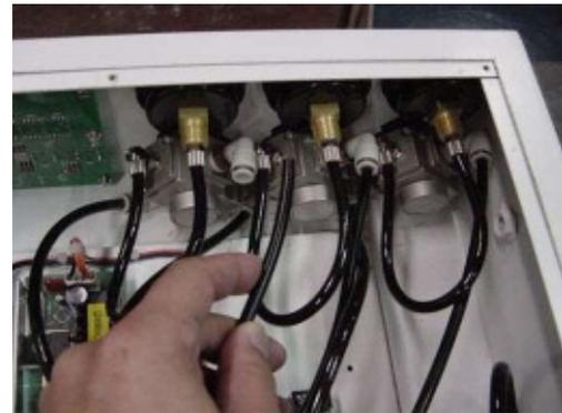
手順-3 圧力計及び減圧弁(パネルマウント)のセットナットを外して下さい。
