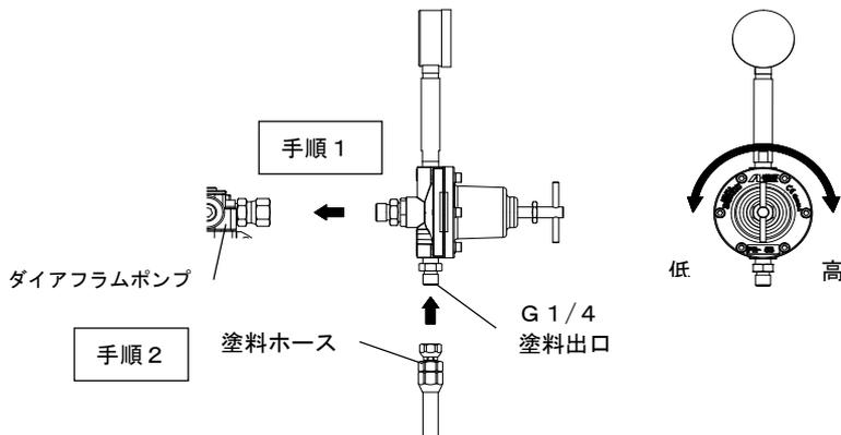
**接続例** 手順1 ダイアフラムポンプの塗料出口にPR-5Bを取付けます。
