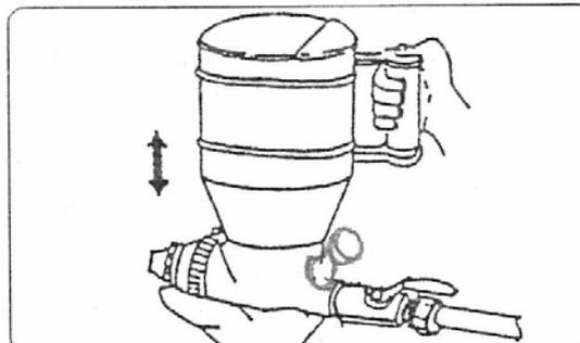
・作業中断時、使用しないときは、洗浄するか、空気ノズルからエアを少量吐出させた状態でノズル又は口金部を水の中に浸けておいてください。作業時の状態で放置しておきますと、塗材が乾き、固着します。
