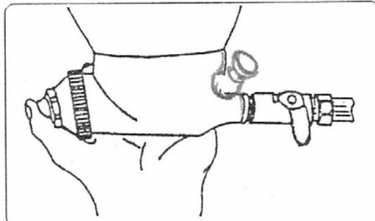
・吹付方法として、ガンを少し上下方向に振りながら吹付けますと、高粘度塗料が落ちやすく、安定して良い模様や、塗材が出やすく使いやすくなります。
