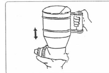
・作業中断時、使用しないときは、洗浄するか、空気ノズルからエアを少量吐出させた状態でノズル又は口金部を水の中に浸けておいてください。作業時の状態で放置しておきますと、塗材が乾き、固着します。
