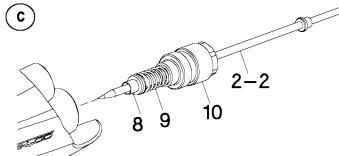
空気弁を交換するときは、塗料調節ガイド、空気弁バネ、空気弁の順に本体セットから取り外してください。
