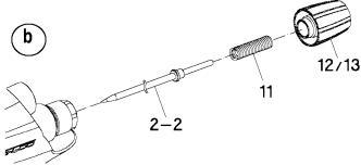
塗料調節つまみ、ニードル弁バネを外し本体セットより引き抜きます。
