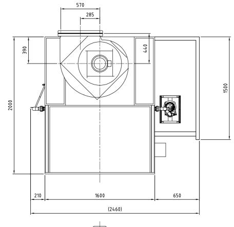
主な仕様平均風速0.6 m/s排気風量110 m²/min水量900 l排気ファンNo, 3½ ターボファン
